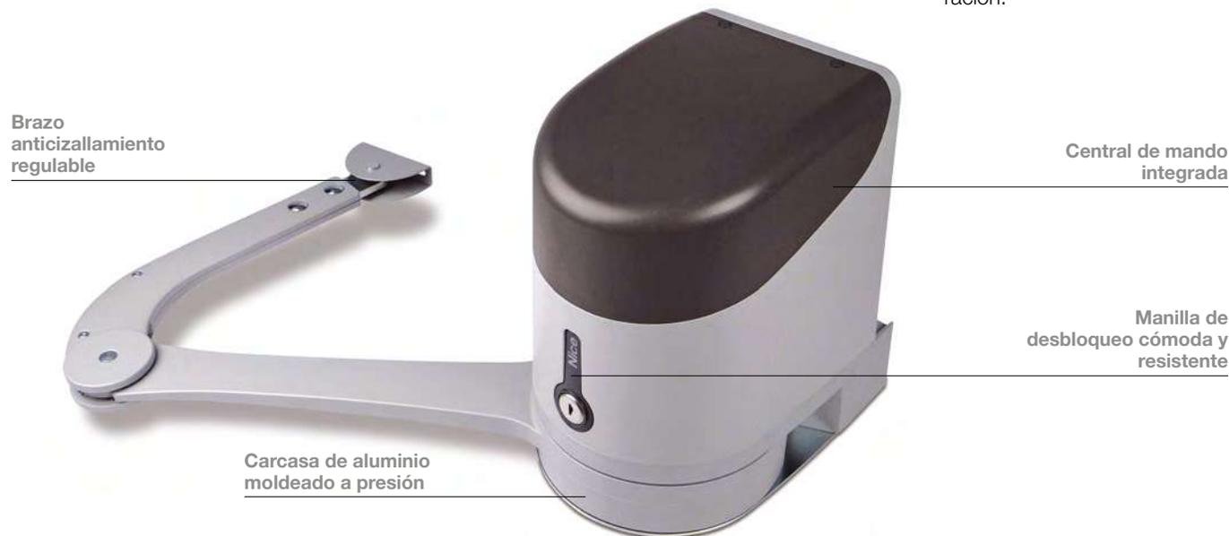
Motorreductor electromecánico irreversible con brazo articulado, montaje exterior, 24 Vdc y encoder magnético.
